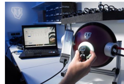
Messung der Lichtleistung
